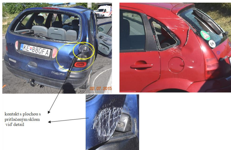
Obr. 4 Určenie kontaktu zadných častí vozidiel Renault a Citroen podľa fotodokumentácie
