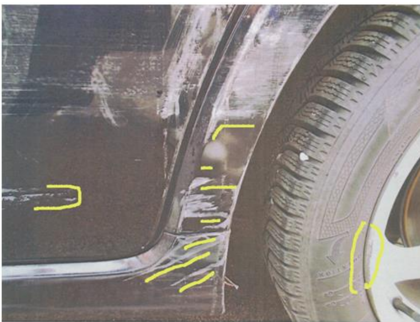
Obr. 3 Analýza lokalizácie, rozsahu a charakteru poškodenia vozidla Honda [7]
