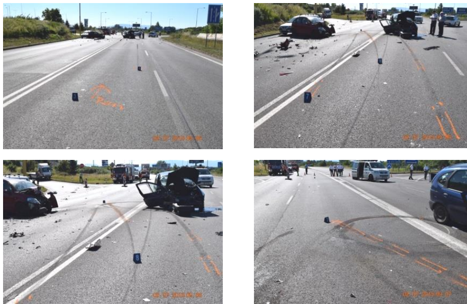
Obr. 3 Pohľady na zanechané stopy a na deformácie vozidiel z fotodokumentácie
