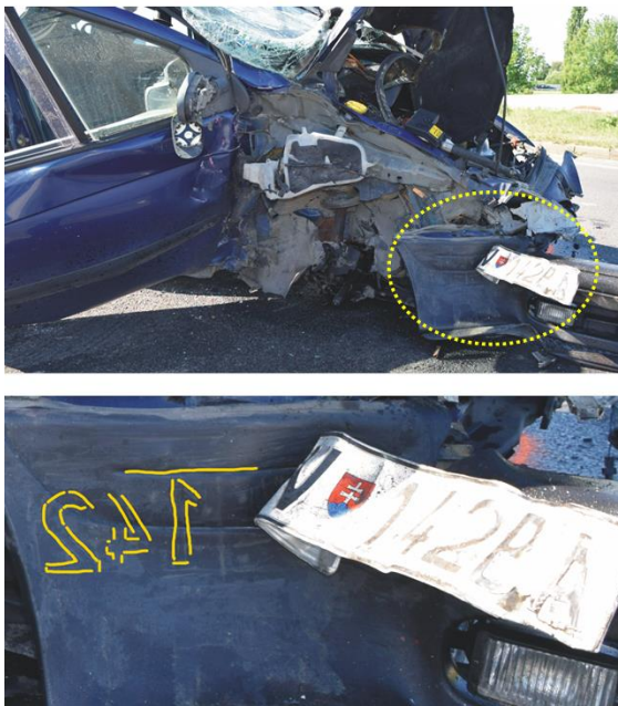
Obr. 5 Určenie miesta nárazu vozidla Citroen do PP časti P nárazníka vozidla Renault podľa fotodokumentácie
